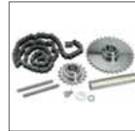
Groupe de renvoi du mouvement 1:1,8 pour arbre 1" (25,4 mm) composé de deux engrenages d'un diamètre extérieur de 78 mm et 138,4 mm et d'une chaîne L= 1 m
