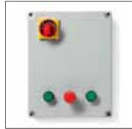
Centrales START/THINK avec boutons d'ouverture, fermeture et arrêt à accrochage et interrupteur tripolaire avec bloque - porte incorporés dans le tableau de commande. Boîte résistante pour utilisation en environnement industriel, indice de protection IP 55. Caractéristiques complètes page 159
